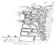
Degradazione diffusa del coronamento, della base e di una parte superiore del muro
