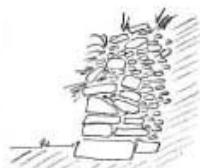
Degradazione diffusa del coronamento, della base e di una parte superiore del muro
